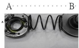
7. (1) 有關 CVT 變速機構，若驅動盤與傳動盤的傳動有效半徑分別為 3 cm 與 5 cm，傳動效率為 90%，當驅動盤的轉速為 2000rpm，傳動盤的轉速為多少 rps (revolution per second)？ ①18 ②20 ③22 ④24。
