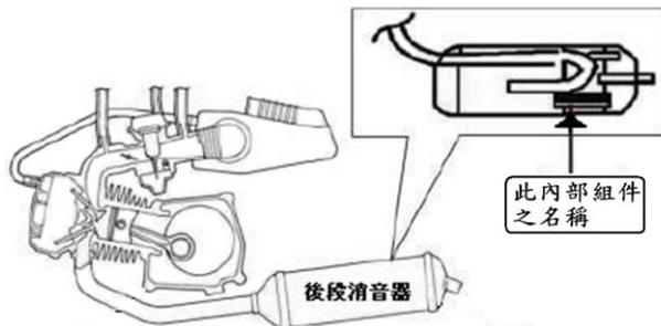
10. (1) 有關圖示元件之量測，下列何者正確？ ①三用電錶需選擇在歐姆錶檔位 ②三用電錶需選擇在電壓錶檔位 ③三用電錶需選擇在電流錶檔位 ④三用電錶需選擇在轉速錶檔位。
