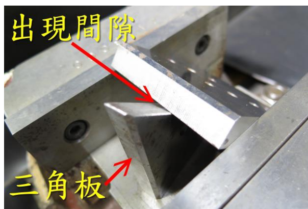
圖 7 工件與三角板未貼緊示意圖
