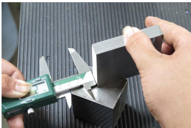
圖 11 扁鐵工件與治具槽深比對圖
