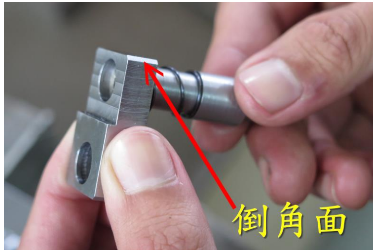
圖 1 常見倒角加工示意圖
