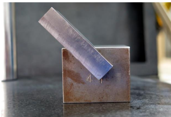
圖 17 倒角治具溝槽插入工件圖
