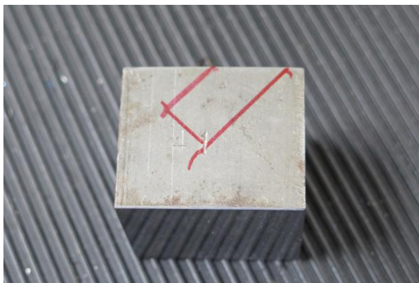
圖 12 治具溝槽繪製完成圖
