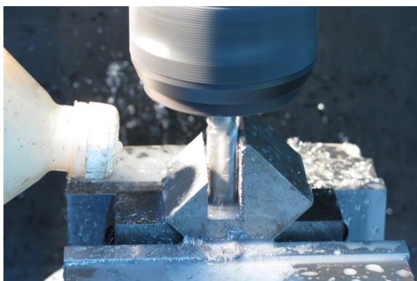
圖 14 四刃平銑刀進行精銑削圖
