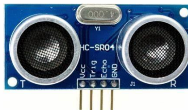
圖 3 HC-SR04 超音波感測器外觀及接腳圖
