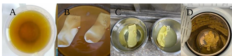
圖 7、被染物染色流程，A 量取煮好之染液、B 進行煮染、C 利用媒染劑進行媒染、D 被染物經水洗後利用脫水機將水脫乾。
