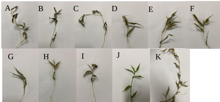
圖 8、十一種處理之蘆葦染材，A 組蘆葦：40℃烘乾 24 小時、B 組蘆葦：40℃烘乾 48 小時、C 組蘆葦：40℃烘乾 72 小時、D 組蘆葦：80℃烘乾 24 小時、E 組蘆葦：80℃烘乾 48 小時、F 組蘆葦：80℃烘乾 72 小時、G 組蘆葦：100℃烘乾 24 小時、H 組蘆葦：100℃烘乾 48 小時、I 組蘆葦：100℃烘乾 72 小時、對照組 J 組：新鮮蘆葦、對照組 K 組：日曬蘆葦。
